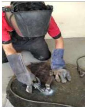
Gambar 4. 17 pembuatan tempat pengangkat penutup ruang pembakaran
