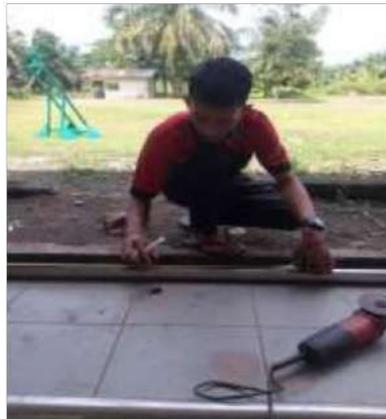
Gambar 4. 26 Proses pengukuran pipa besi
