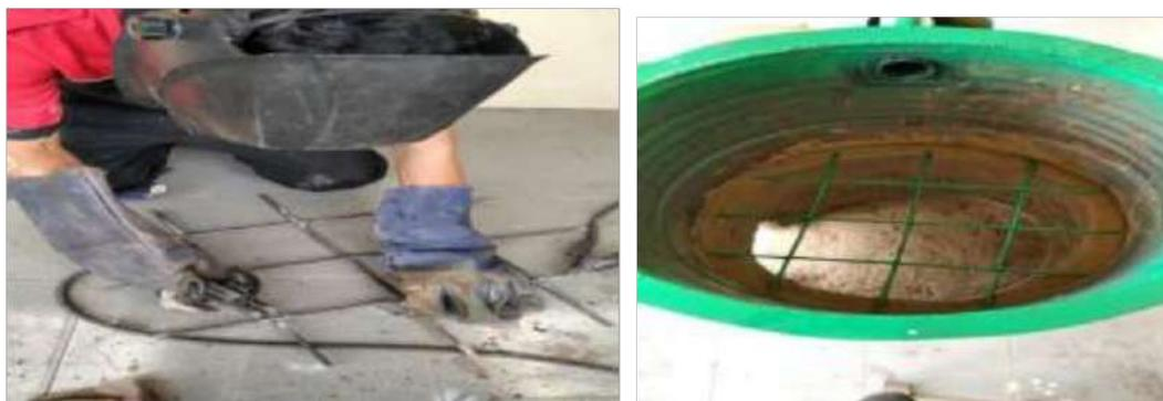
Gambar 4. 16 proses pembuatan pembatas di tungku pembakaran
