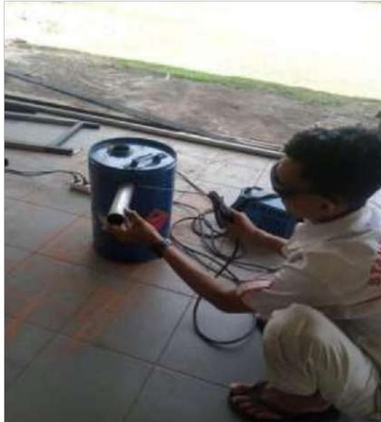
Gambar 4. 20 Proses pengelasan pipa pada tempat asap
