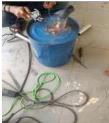
Gambar 4. 21 proses pengelasan pipa tempat keluar asap cair
