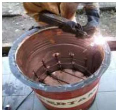
Gambar 4. 10 Proses Pengelasan untuk Rangkaian penutup
