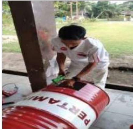
Gambar 4. 5 Proses pemasangan pintu bagian tungku ruang pembakaran
