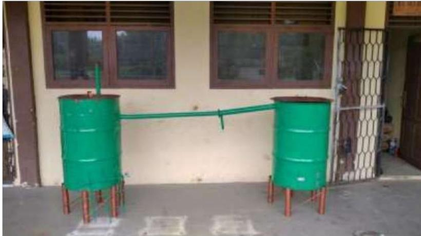
Gambar 4. 33 hasil pembuatan Insinerator ramah lingkungan
