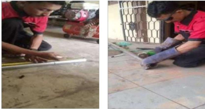
Gambar 4. 7 proses pengukuran dan pemotongan rangka kaki
