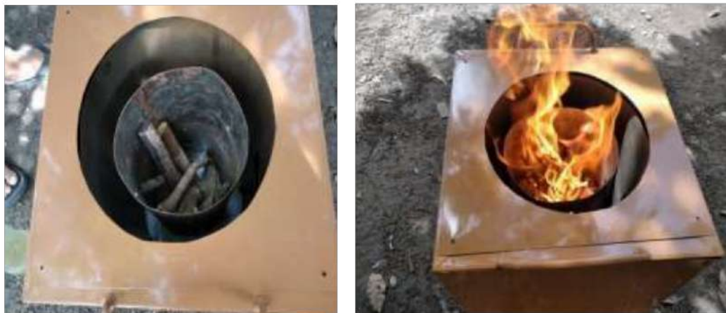
Gambar 4.11 pengujian dengan 1 kg kayu karet dan Api kompor biomassa
