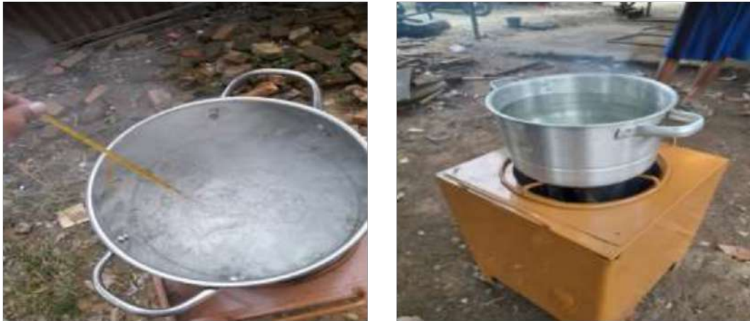
Gambar 4.12 Pengujian 1kg kayu karet dengan 5 Liter Air
