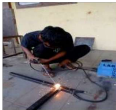
Gambar 4.9 pengelasan kaki bagian luar Sumber: Dokumentasi Pribadi
