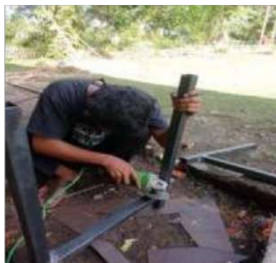
Gambar 4.11 Proses pembersihan kerak las
