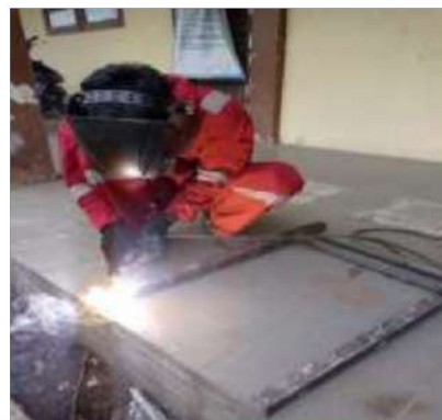
Gambar 4.8 pengelasan rangka kaki bagian dalam Sumber: Dokumentasi Pribadi
