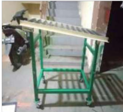
Gambar 4.14 posisikan roller pada tempat jatuhnya material Sumber: Dokumentasi Pribadi
