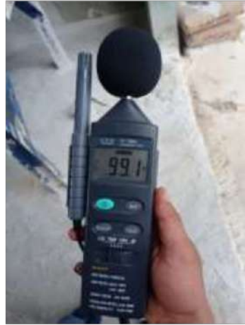
Gambar 4.14 Hasil Pengukuran Kebisingan Motor Diesel
