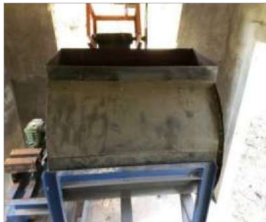
Gambar 2.7 Mixer Bata Ringan Sumber : Labor Teknik Industri
