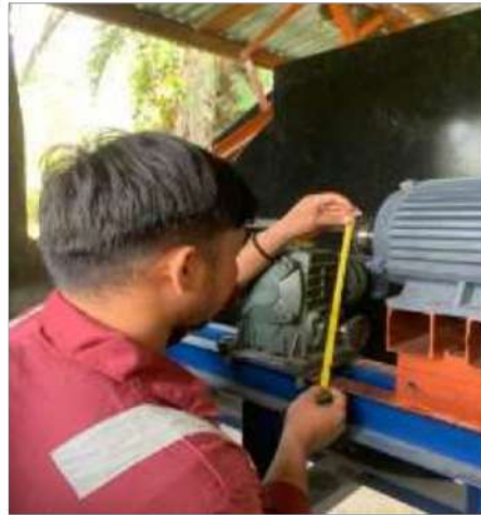
Gambar 4.2 Pengukuran Jarak Antar As Sumber : Dokumentasi Pribadi
