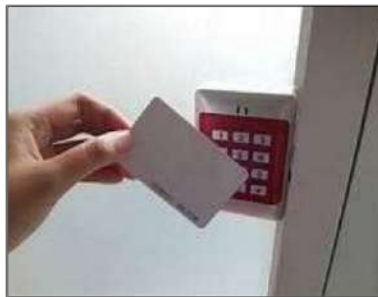
Gambar 4.3 Kunci Pintu Otomatis Menggunakan Kartu ( RFID )
