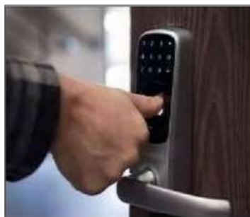
Gambar 4.2 Kunci Pintu Otomatis Menggunakan Sidik Jari.
