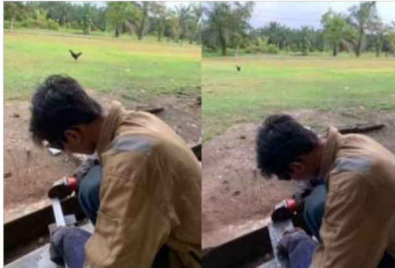
Gambar 4.6 Proses Pemotongan Material
