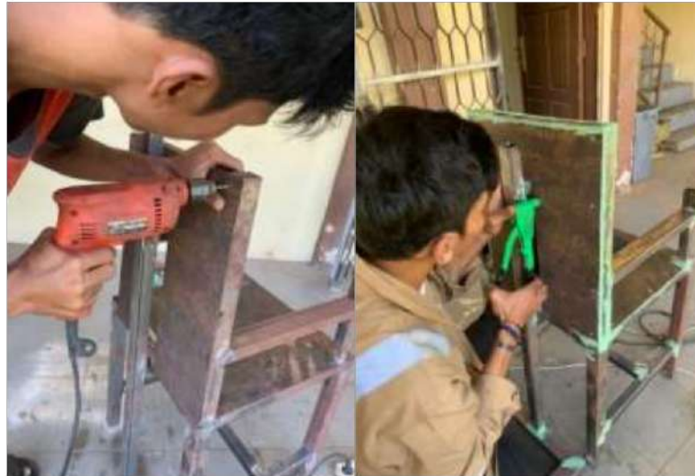
Gambar 4.8 Proses Pengeboran Kerangka Kursi Antropometri
