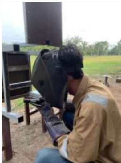
Gambar 4.7 Proses Pengelasan Kerangka Kursi Antropometri
