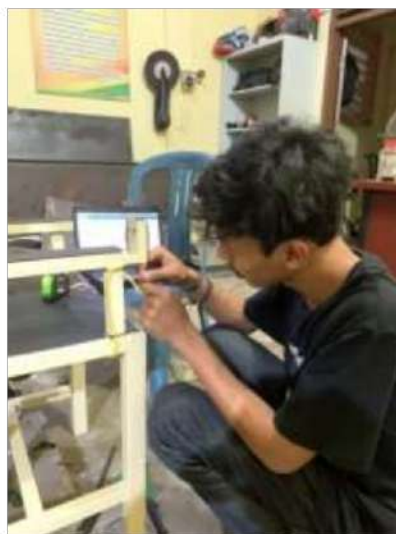
Gambar 4.12 Proses Pemasangan Sensor HC-SR04 ke Kursi Antropometri
