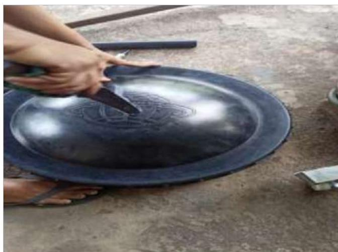
**Gambar 4. 11** Pelubangan tutup digester
