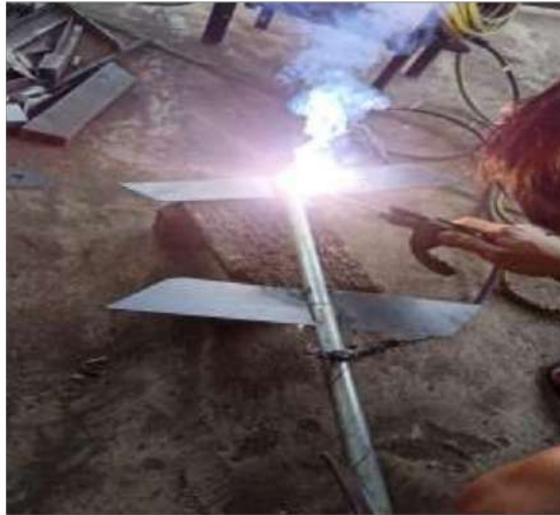
**Gambar 4. 10** Pengelasan blade ke besi poros
