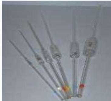
2. **Pipet ukur.** Pipet ini memiliki skala, digunakan untuk mengambil larutan dengan volume tertentu. Gunakan bulb atau karet penghisap untuk menyedot larutan, jangan dihisap dengan mulut.
