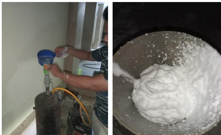
Gambar 4. 9. Pembuatan FA Menggunakan Foam Generator
