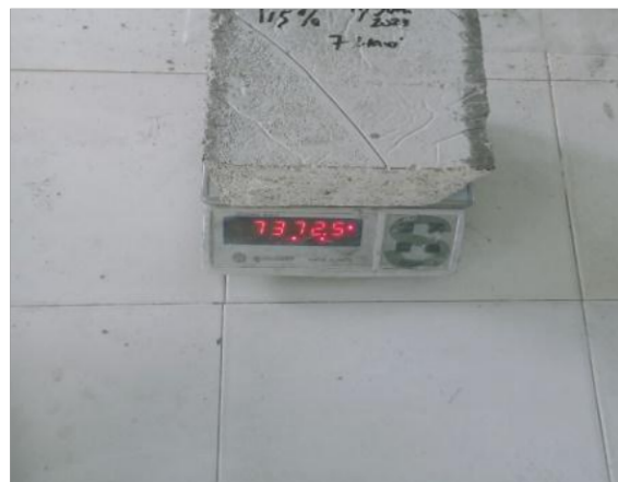
Gambar 4. 15. Penimbangan Sampel Kondisi Kering Oven
