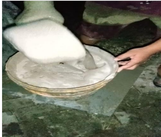
Gambar 4. 10. Pengadukan Mortar dan FA
