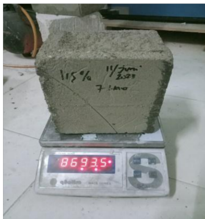
Gambar 4. 16. Penimbangan Sampel Kondisi Kering Permukaan
