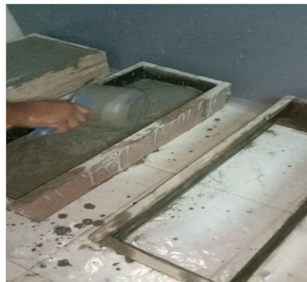
Gambar 4. 11. Proses Pencetakan Sampel
