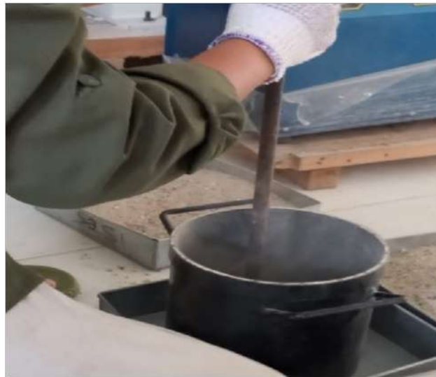
Gambar 4. 14 Proses pemadatan pengujian berat isi
