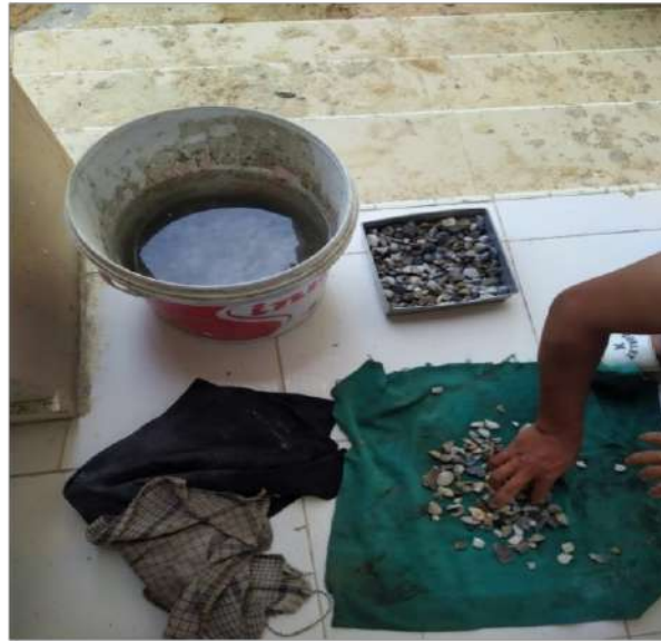
Gambar 4. 17 Proses pengeringan agregat kasar
