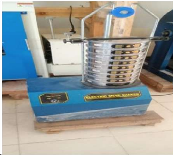
Gambar 4. 18 Alat pengguncangan saringan
