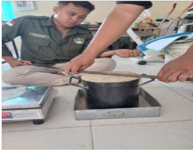
Gambar 4. 15 Proses meratakan pasir menggunakan mistar perata
