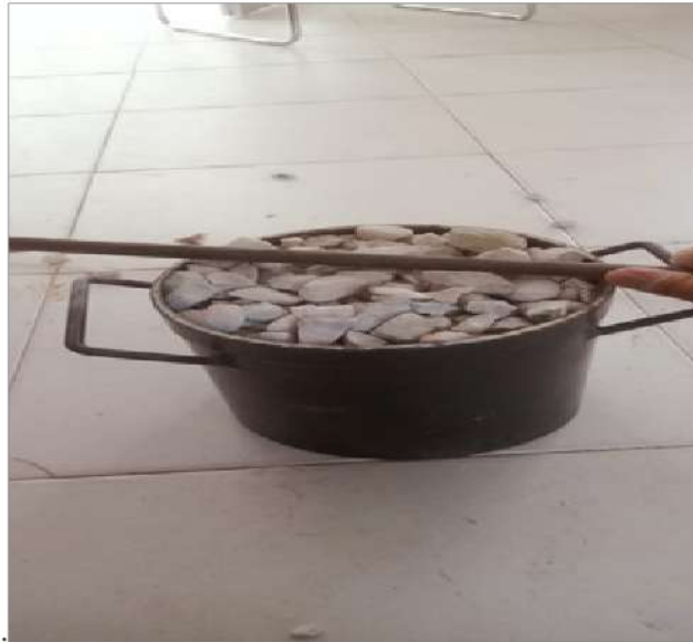
Gambar 4. 20 Proses meratakan permukaan benda uji dengan menggunakan mistar
