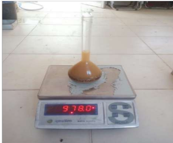
Gambar 4. 2 Píknometer berisi air dan pasir
