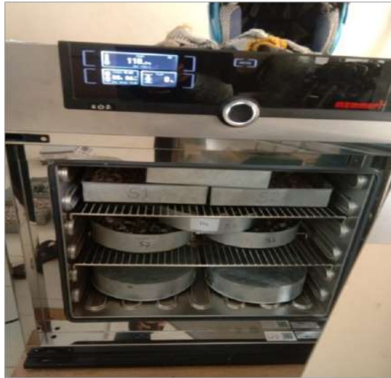
Gambar 4. 16 Proses pengovenan agregat kasar
