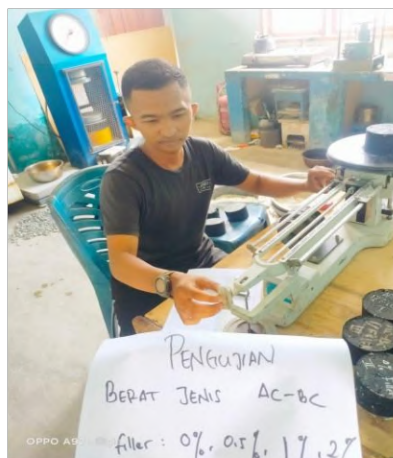
Gambar 4. 8. Proses Penimbangan Benda Uji Sumber: Dokumentasi Penelitian
