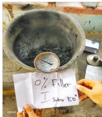
Gambar 4. 6. Pengecekan Suhu Campuran Sumber: Dokumentasi Penelitian
