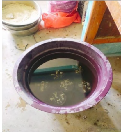
Gambar 4. 9. Rendaman Benda Uji Sumber: Dokumentasi Penelitian
