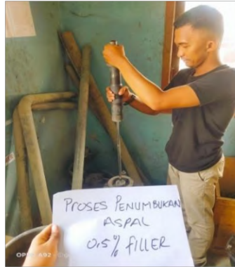
Gambar 4. 7. Proses Pemadatan Benda Uji Sumber: Dokumentasi Penelitian
