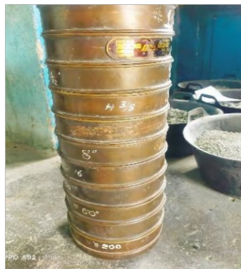
Gambar 4. 1. Susunan Ayakan Sumber: Dokumentasi Penelitian
