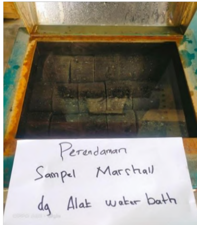
Gambar 4. 11. Perendaman Benda Uji di Water Bath Sumber: Dokumentasi Penelitian
