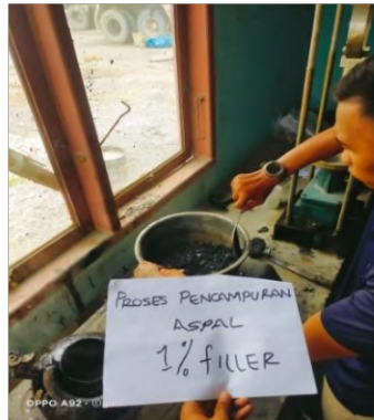
Gambar 4. 5. Pencampuran Bahan untuk Benda Uji Sumber: Dokumentasi Penelitian
