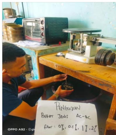
Gambar 4. 10. Proses Penimbangan Benda Uji di dalam Air Sumber: Dokumentasi Penelitian
