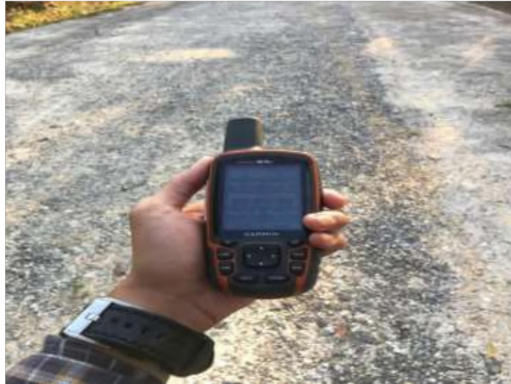
Gambar 4. 13 Mengambil Titik kerusakan Jalan ( dokumentasi lapangan )
